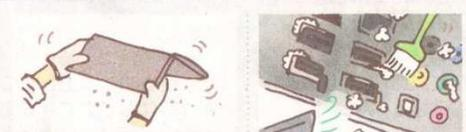
デスクトップパソコンでもノートパソコンでも、キーボードの隙間からごみが入りがち。エアダスターで飛ばしてもいいが、ひっくり返して左右に振ると落としやすい
